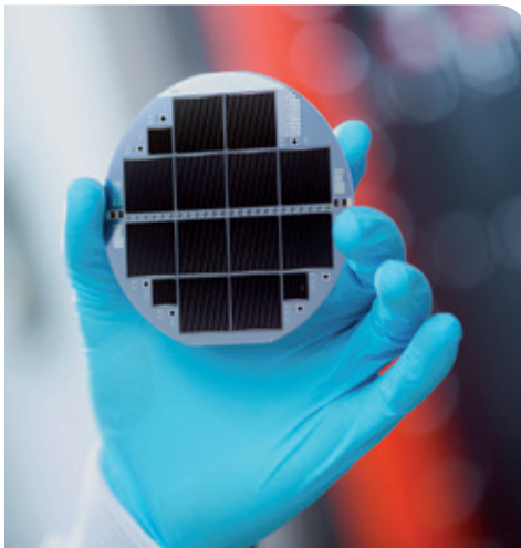
Mehrfachsolarzelle aus III-V-Halbleitern und Silicium, die 33,3 Prozent des Sonnenlichts in Strom wandelt.
