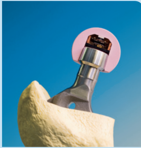
In den Gelenkkopf ist die Sensorik integriert, mit der eine Lockerung des Implantats gemessen werden kann. © Fraunhofer IPMS
